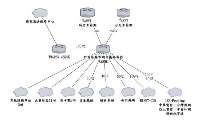
竹苗區網以 ASR9K 為核心,大部分連線單位透過一條光纖接入,區網中心提供 1G 介面進行連線;部分連線單位透過 ISP 收容後共用一條光纖接入區網中心;縣市網中心接使用兩條光纖接入,區網中心提供兩個 10G 介面進行連線。
